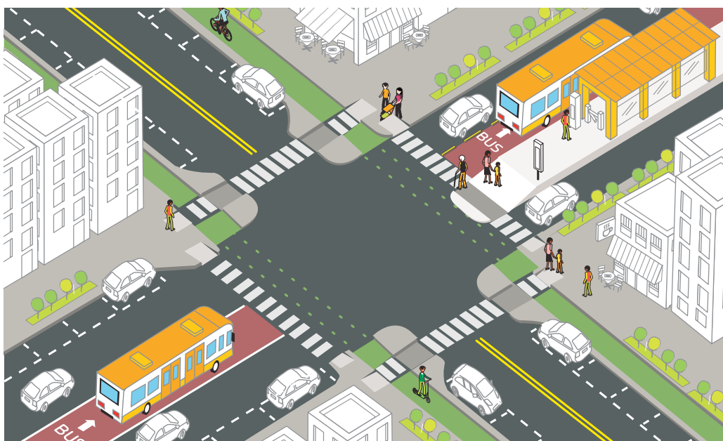
Carril de autobús que divide en pares unidireccionales la vía, alineado al centro de la calle
