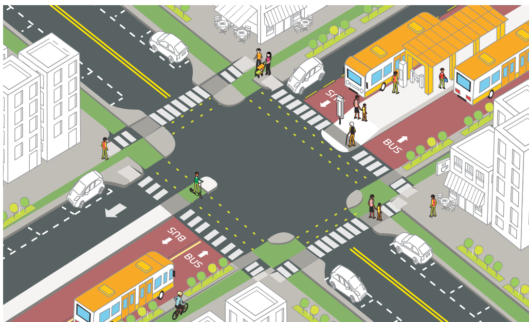
Carril de autobús de dos sentidos que circula lateral a una calle de un sentido
